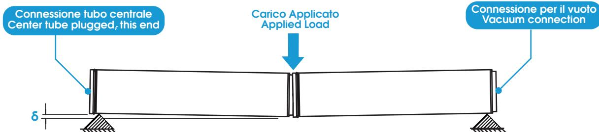
**Figure 14:** Test del vuoto in relazione alla flessione/Test setup for vacuum test with bending
