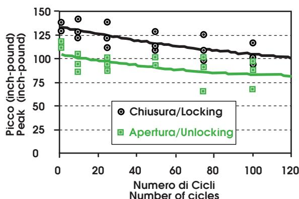
**Figure 13:** Misurazione dei momenti di picco di una simulazione di apertura e chiusura degli elementi
