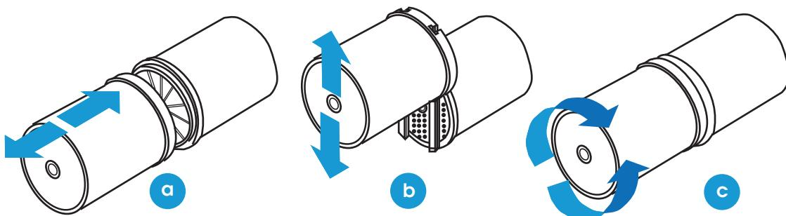
**Figura 4:** Tre esempi di interconnessione meccanica tra elementi
