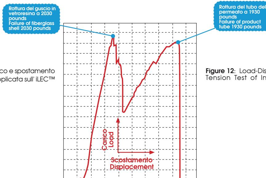
Figure 12: Curva di carico e spostamento dovuta alla tensione applicata sull'iLEC™
