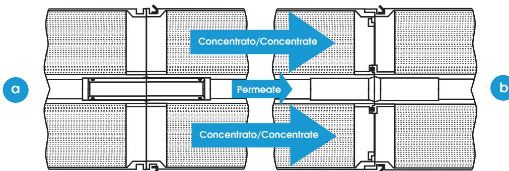
**Figure 6:** Confronto tra due interconnessioni sezionate. La figura (a) rappresenta un interconnettore standard ad inserto, la figura (b) il nuovo sistema iLEC™.
