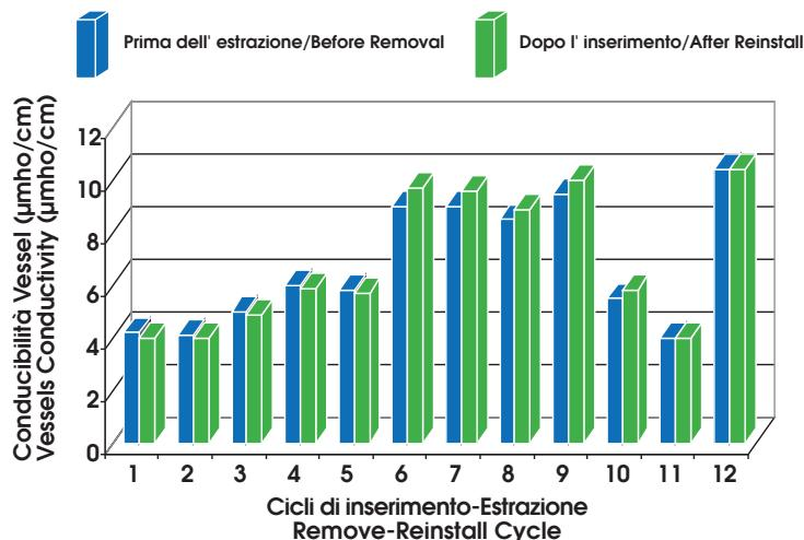
**Figura 7:** Conducibilità permeato prima dell' estrazione e dopo l' inserimento
