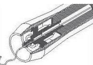
Ruotare la valvola a disco e spingere il tubo fino alla fine del vessel.
