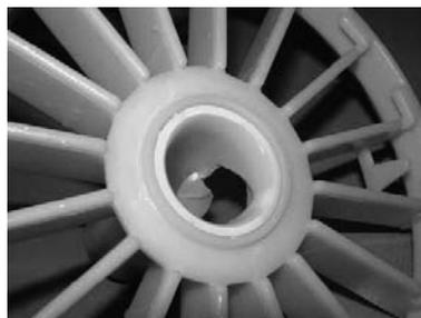
**Figure 16:** Rottura del tubo permeato nell'area adiacente alla connessione col tappo/
